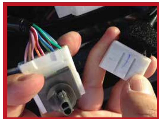
Lo sacamos de su anclaje con la punta de un destornillador
